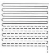
Метод укладання змієвик
