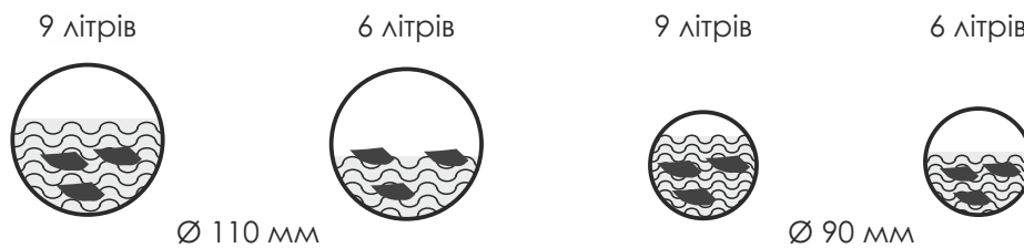
Рис. 19 – Схема протікання стічних вод по трубопроводу
