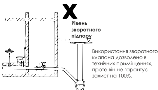
Невірне прокладання напірного трубопроводу
